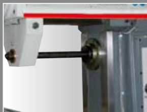
卧铣位置 · 加装卧铣挂架,可夹持侧面铣刀
