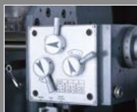
工作台走刀器 · 电机带X和Y轴工作台齿轮式进刀
