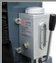
· 手动润滑泵 · Lubricant pump
