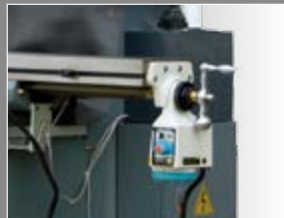
X轴走刀器 · 带无极变速调节
