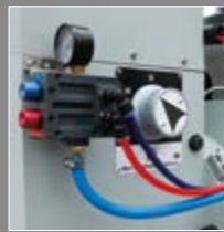
· 气动换刀 · Pneumatic tool changer
